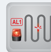
Alarma de calefactor abierto
