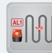
Alarma de lazo de control abierto (LBA)
