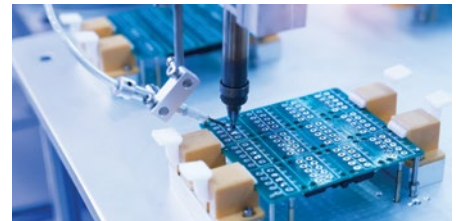
Comprobación de presencia de componentes de PCB
